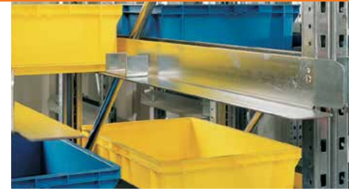
Jednomístný systém skladování dvou jednotek za sebou (ve dvojnásobné hloubce) (obsluha regálů z obou stran)
