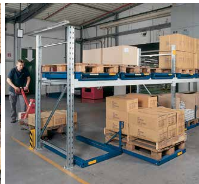
Vysunovací přípravek v přízemní části a na travverzách
