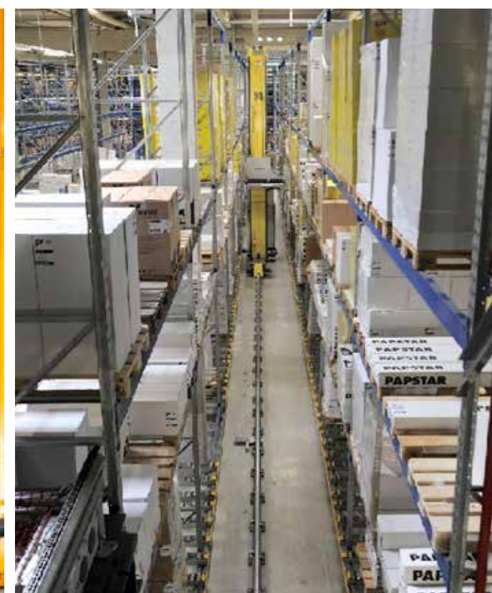
Papstar, uskladnění palet. V nejnižší úrovni se uskladňují palety do spádových kanálů k vychystání pro oblast kompletace.
