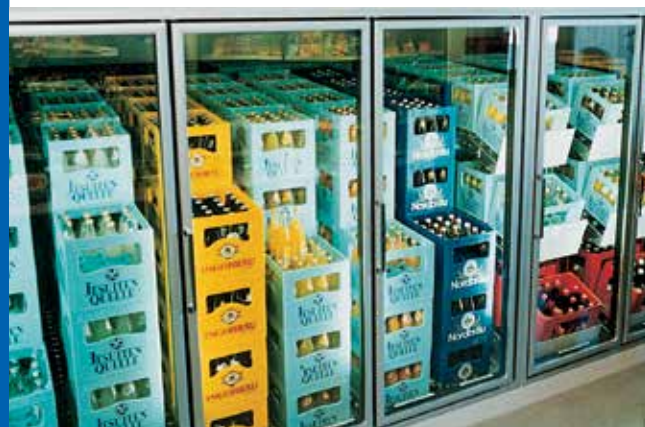
Úrovně zakončené nakloněnou rovinou na kompletaci po jednotlivých lahvích a vodorovné úrovně na odběr celých beden
