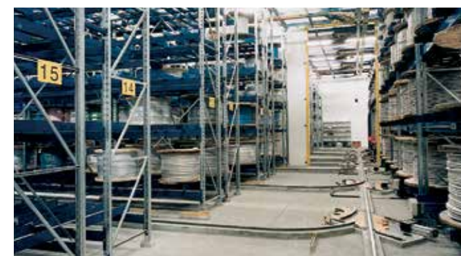
Zařízení na obsluhu regálů s řízeným průjezdem zatáček
