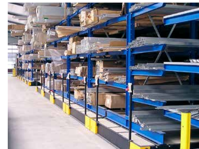
Sestava pojízdných regálů s konzolovými rameny na skladování dlouhých předmětů
