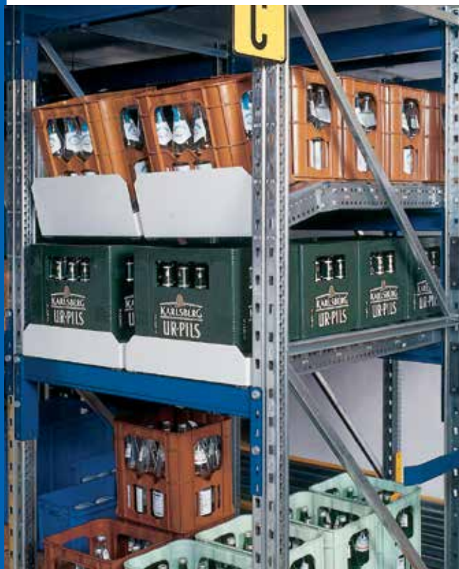
Úrovně zakončené nakloněnou rovinou na kompletaci po jednotlivých lahvích a vodorovné úrovně na odběr celých beden
